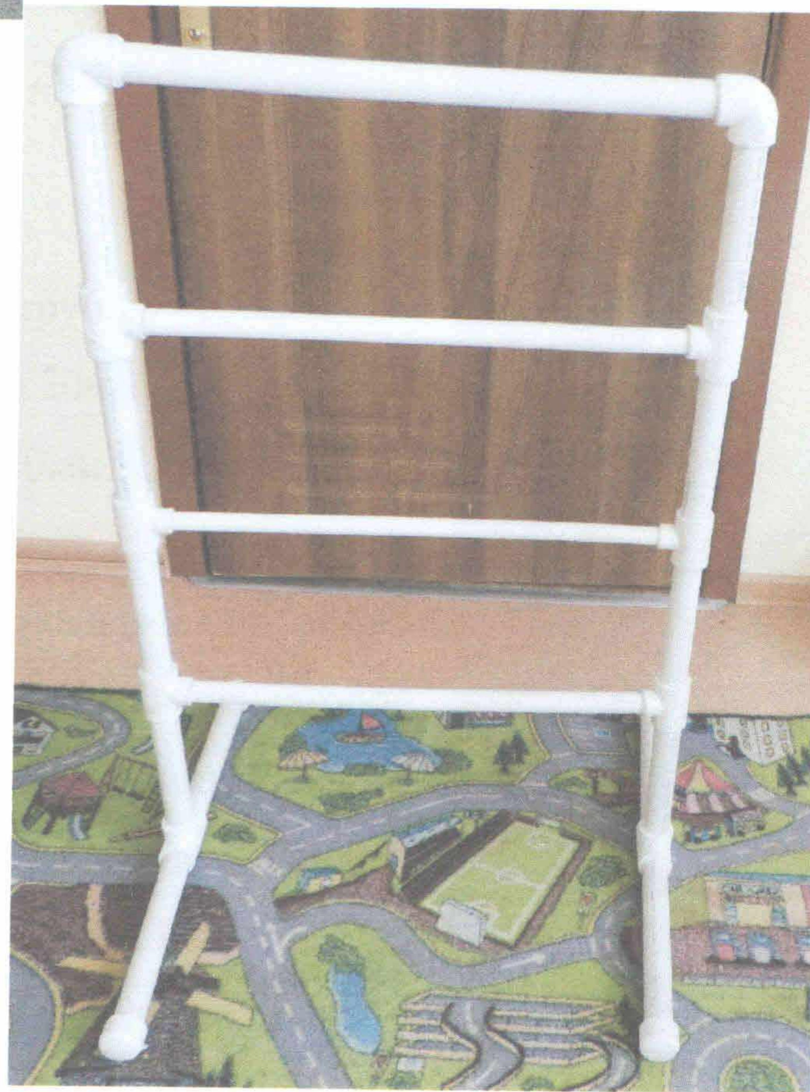
трубе). На отрезные стороны опорных частей установлены заглушки  $\varnothing$  20мм. Опорная и основная часть соединяются тройниками  $\varnothing$  20мм. Перемычки соединяются с основной частью тройниками, параллельные отверстия которых  $\varnothing$  20мм, а боковое  $\varnothing$  15мм.
